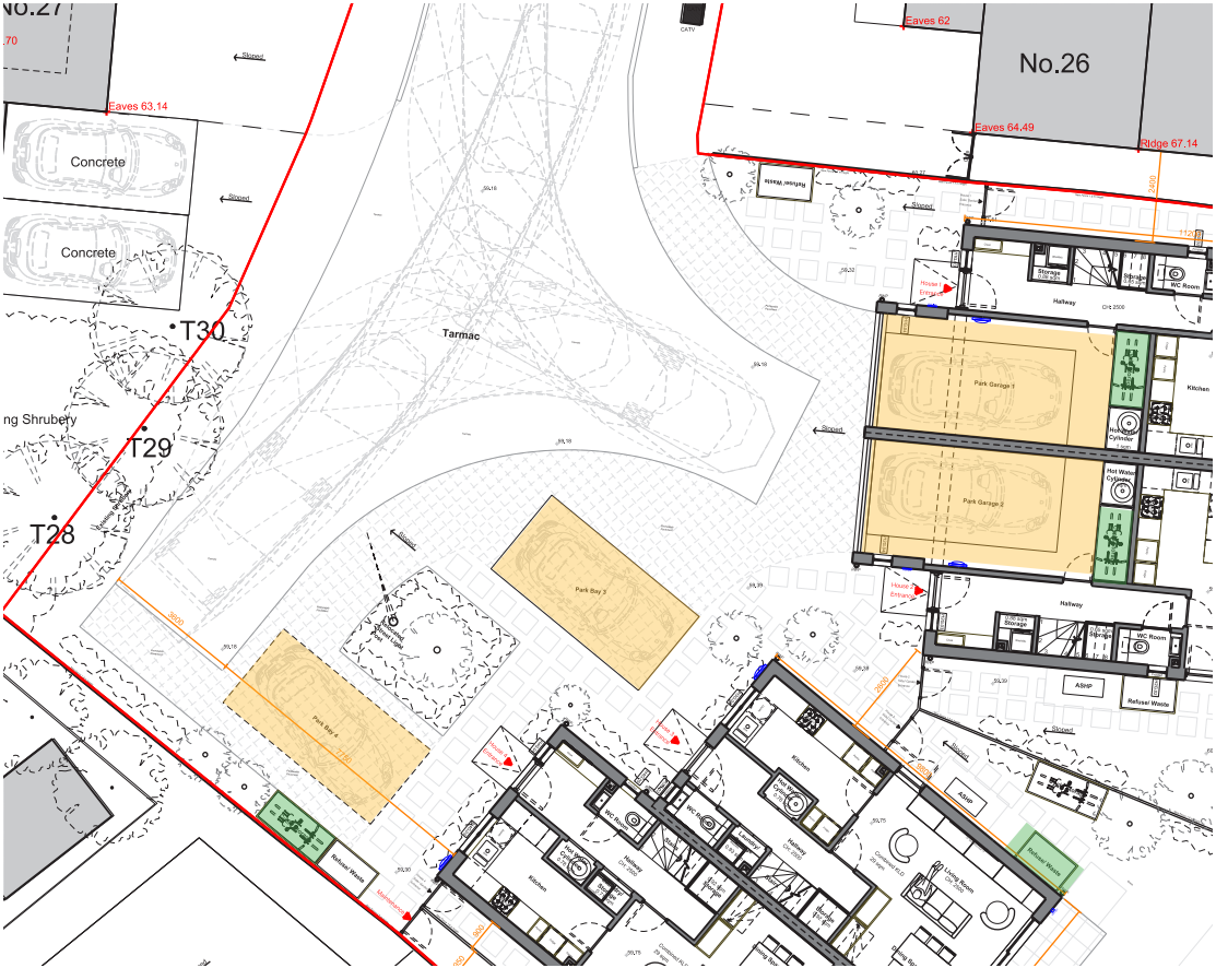
Vehicle Swept Path Analysis (extract from TTP Consulting)
